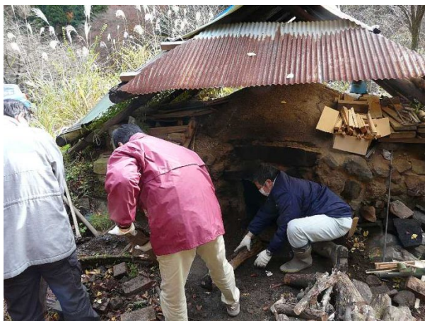
窯の中の人に手渡しで原木を運び入れる作業
