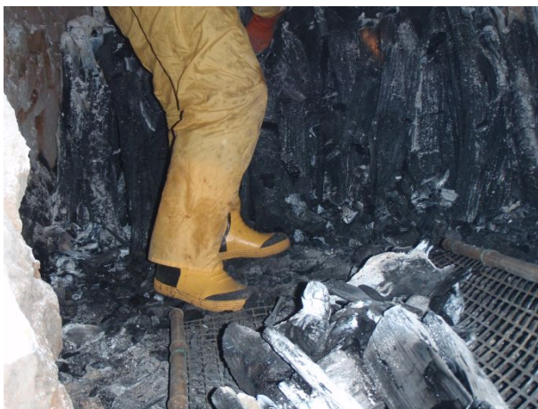
炭出し作業・窯の中の様子
